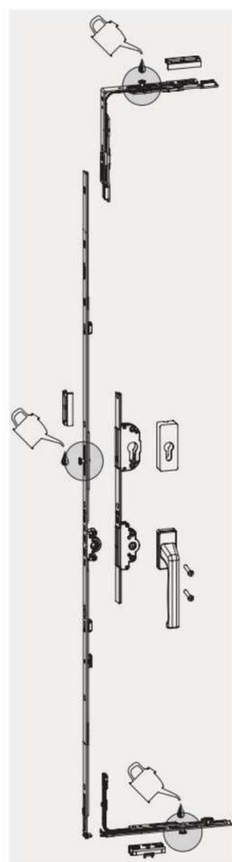
1. Bewegliche Verriegelungsstellen sind gleitfähig zu halten. Dazu säure- und harzfreies Gleitmittel verwenden, um den Korrosionsschutz der Beschlagteile nicht zu beeinträchtigen. Alle Schließ- und Rastplatten fetten.
